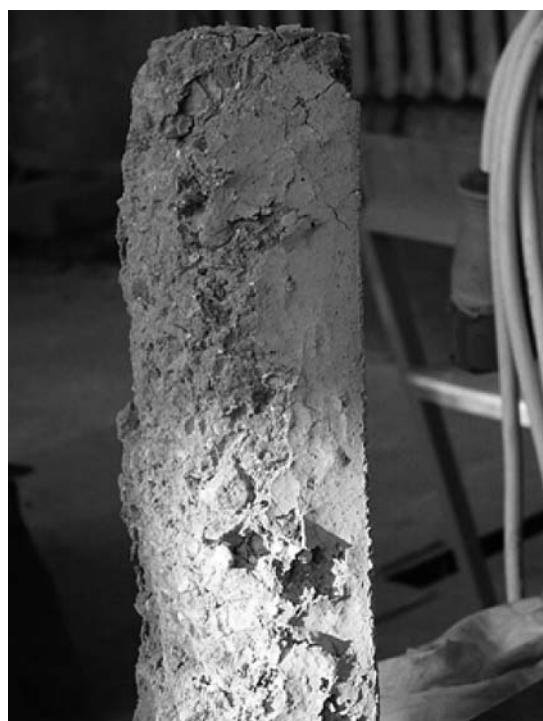
6 pav. Betoninė prizmė kaitinta 800 °C temperatūroje
