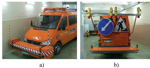
2 pav. Mobili kelių tyrimo laboratorija RST 28 žiūrint iš: a – galo; b – priekio
