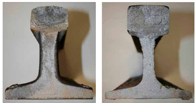
11 pav. Suvirintos termitiniu būdu bėgio jungties BHHD 2,5 min. lūžis. Jokių matomų defektų. Suadymo apkrova 1289 kN, įlinkis 10 mm
