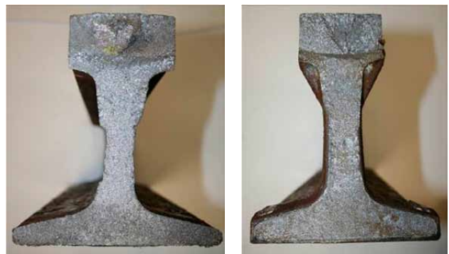
10 pav. Suvirintos termitiniu būdu bėgio jungties BH 5 min. lūžis. Jokių matomų defektų. Suadymo apkrova 1517 kN, įlinkis 12 mm
