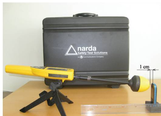
2 pav. Elektromagnetinių laukų matavimo schema Fig. 2. Scheme for measuring the electromagnetic field
